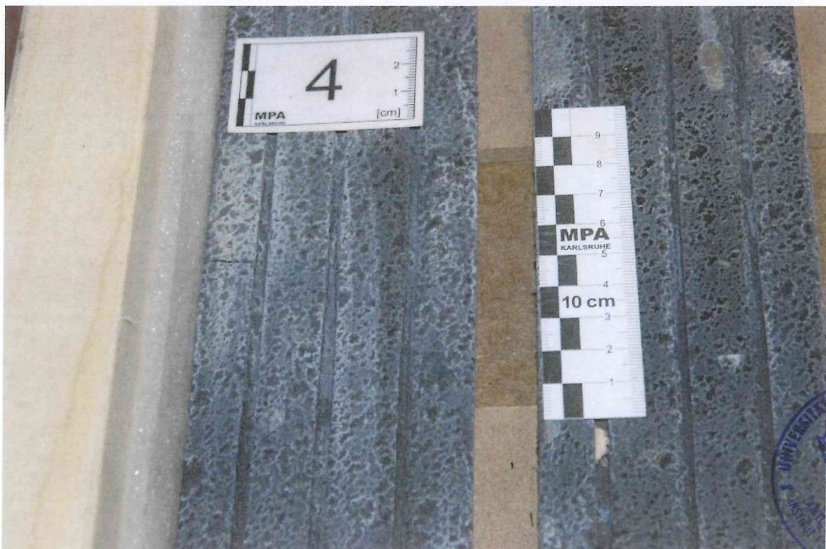
Bild 9: Fußbodenaufbau AB 1 13-0463, Belastungsposition 4 nach Aufbringung der Maximallast
