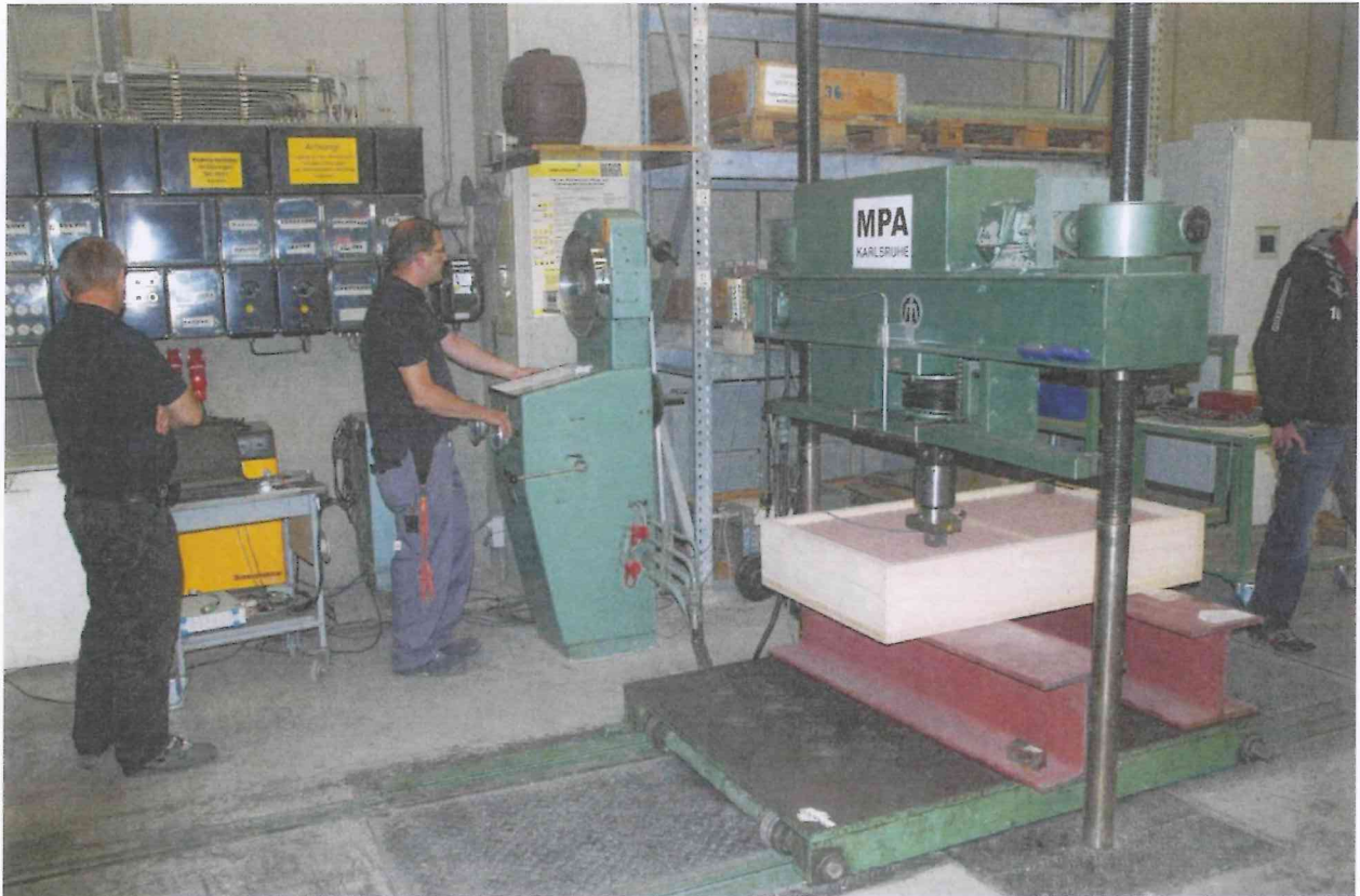
Bild 1: Fußbodenaufbau in der Prüfmaschine mit Belastungsstempel 50 mm x 50 mm, dargestellt ist der Fußbodenaufbau Nr. 2, Belastungsposition 1 (Mitte)
