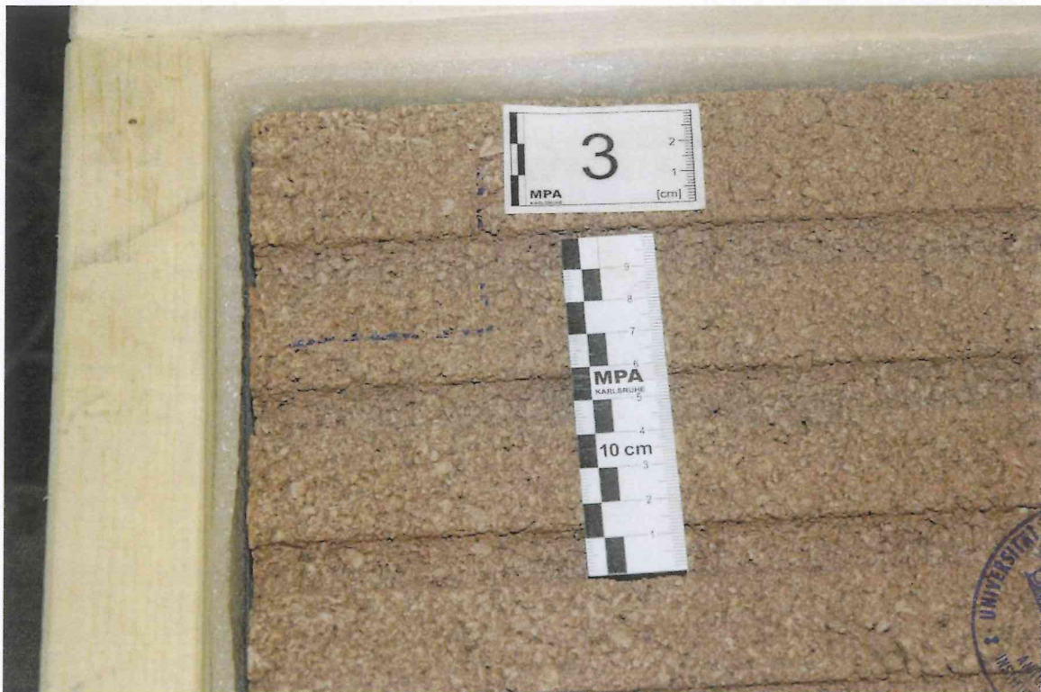
Bild 18: Fußbodenaufbau AB 2 13-0463, Belastungsposition 3 nach Aufbringung der Maximallast
