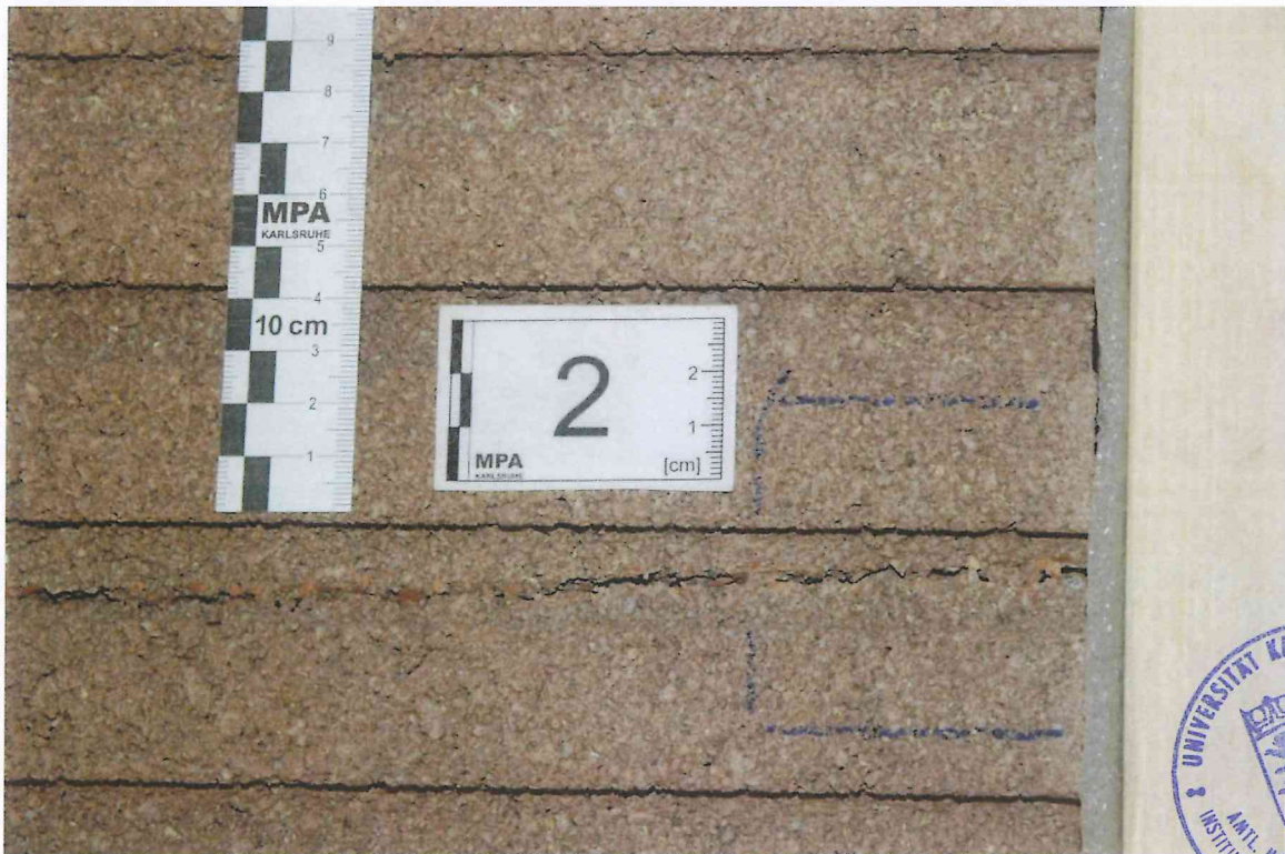
Bild 16: Fußbodenaufbau AB 2 13-0463, Belastungsposition 2 nach Aufbringung der Maximallast
