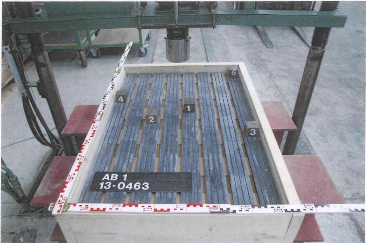
Bild 1: Fußbodenaufbau AB 1 13-0463 mit fünf Belastungspositionen
