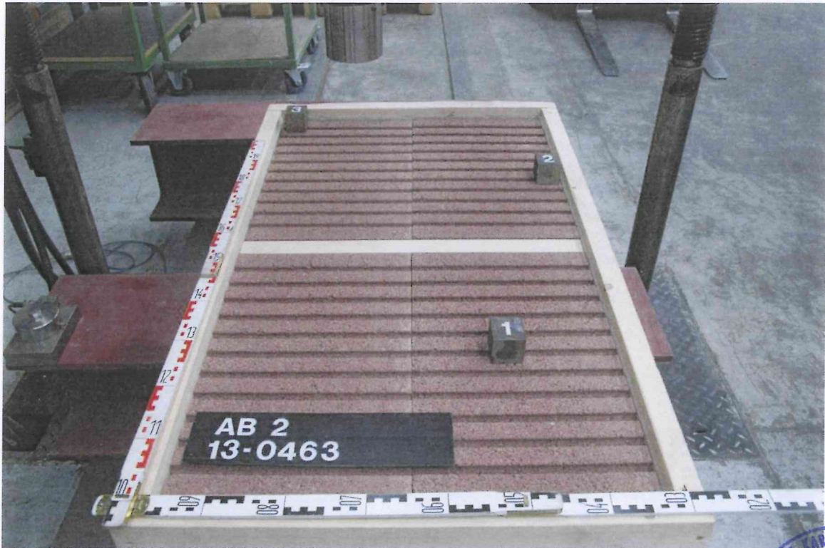
Bild 12: Fußbodenaufbau AB 2 13-0463 mit drei Belastungspositionen
