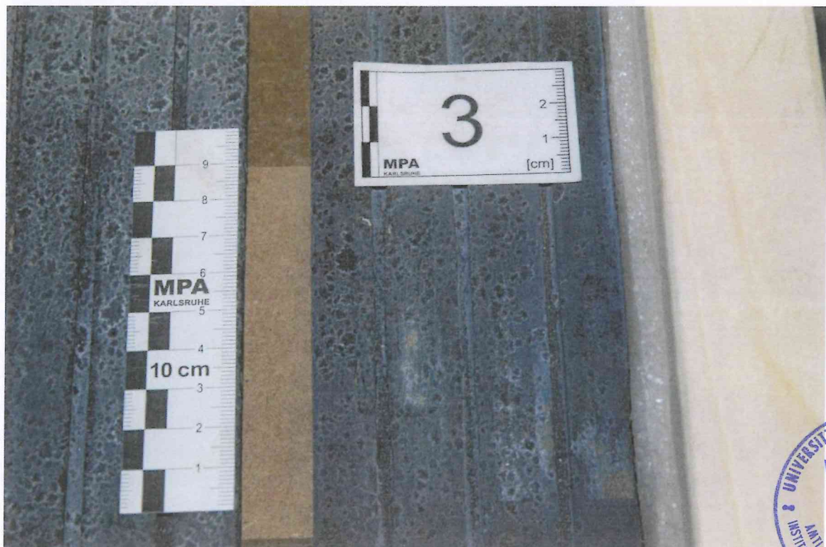
Bild 7: Fußbodenaufbau AB 1 13-0463, Belastungsposition 3 nach Aufbringung der Maximallast
