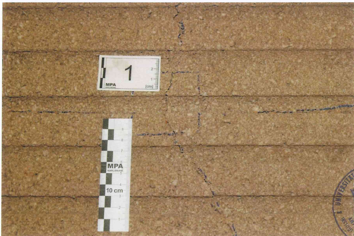
Bild 14: Fußbodenaufbau AB 2 13-0463, Belastungsposition 1 nach Aufbringung der Maximallast
